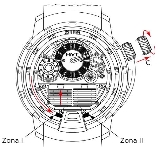
**Importante:** Caso não tencione usar o relógio durante algum tempo, o líquido colorido tem de ser depositado no seu próprio reservatório (no fole esquerdo<sup>2</sup>).
